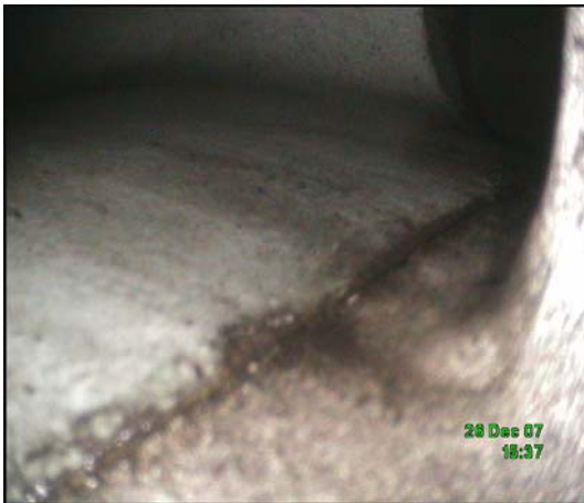
DRUGI VIJENAC SPROVODNOG APARATA – pojava gareži i naslaga ulja
