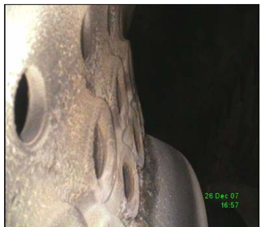
KOMORA SAGORIJEVANJA, deflektori – pojava koks i oksidacije, hemijske korozije, djelimično progrijevanje bez oštećenja
