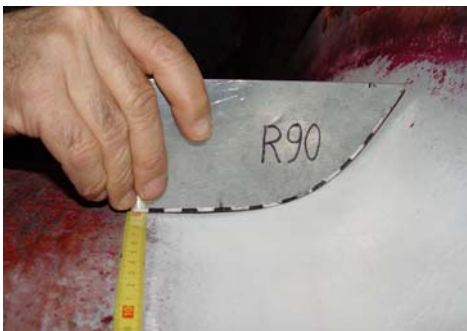
Slika 8. Ispitivanje penetrantima i kontrola prelaznog radijusa nakon sanacije
