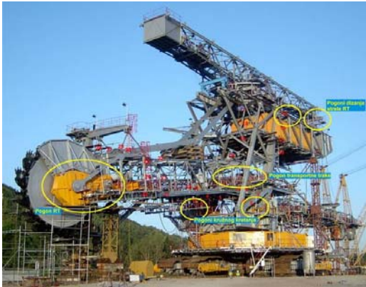
Slika 3. Merna mesta za praćenje napreznja u konstrukciji i pogoni na čijim se ležajevima prate vibracije
