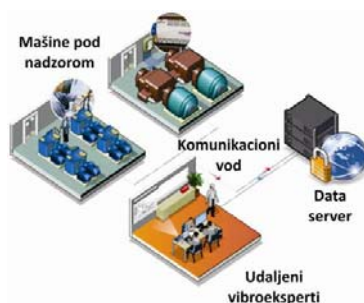
Slika 1. Elementi sistema za daljinski nadzor mašina
