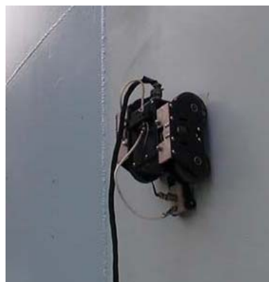
Slika 5. Primjer mehaniziranog UT mjerenja debljine plašta [8]
