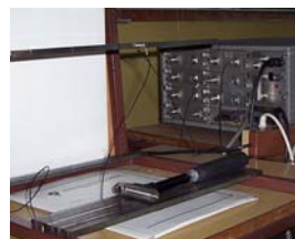
Slika 2. Eksperimentalna postavka grede u slobodnom stanju
