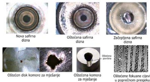
Oštećenja nastala na safirnoj dizni, disku komore za mješane, komore za mješanje i fokusne cijevi [5].
