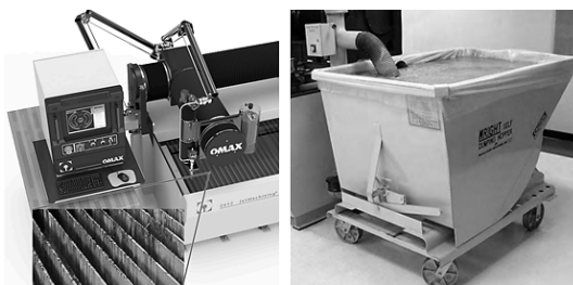
Slika 6. Ispoljene metalne poprečne letvice i sistem za prečišćavanje vode [5] [6] [7].
