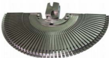
Slika 8. Ploča sa kanalima za prijenosne platine
