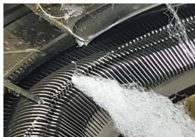
Slika 7. Lom noge, igla ostaje u gornjem položaju
