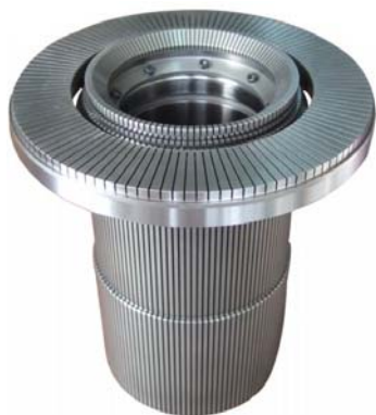
Slika 5. Izgled cilindra kod jednoigleničnog čaraparskog automata
