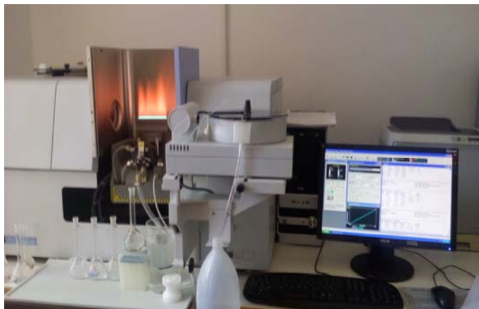
Slika 1. Perkin Elmer analyt 800 AAS [foto Džaferović 2018]
