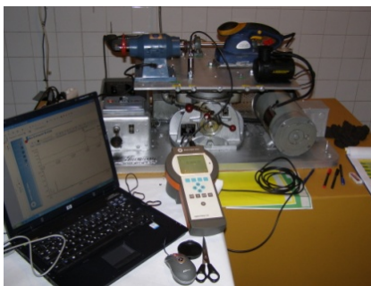
Slika 4. Uređaj korišten za mjerenje vibracija na SSV
