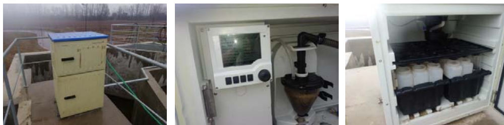
Slika 3. Sampler uređaj, za podesivo automatsko uzimanje uzoraka (20.01.2017.)
