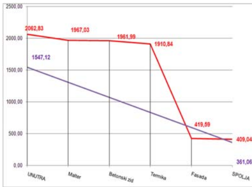
Slika 2. Grafički prikaz provedenog proračuna sa povećanim vrijednostima vlažnosti vazduha unutar
