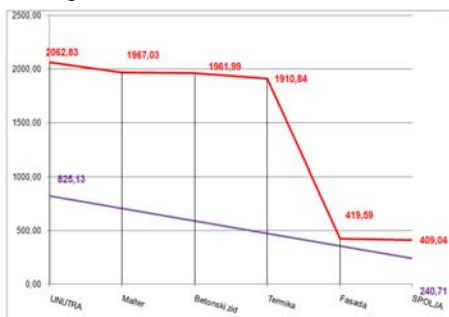
Slika 3. Grafički prikaz provedenog proračuna sa smanjenim vrijednostima vlažnosti vazduha vani
