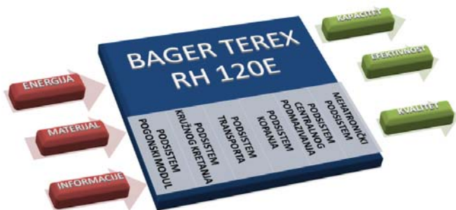
Slika 3. Podsistemi bagera TEREX RH 120 E
